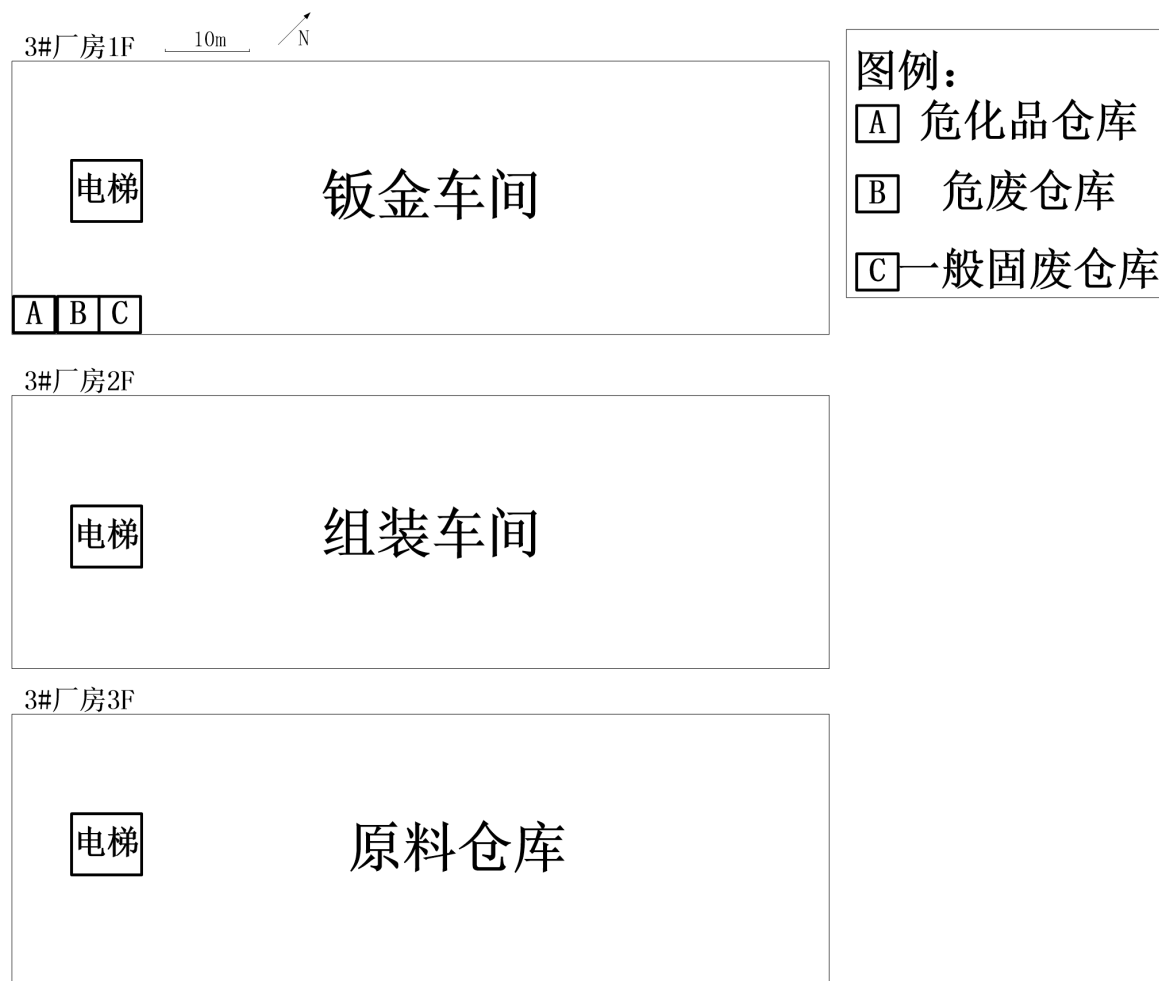
附图 7-4：3#厂房总平面布置图
